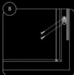
V případě, že tvar nebo velikost zasklívací lišty neumožňuje vrtat otvory pro napínací kolíky do zasklívací lišty shora, volíme možnost otvory pro kolíky vrtat do čela zasklívací lišty. V tomto případě dbáme na to, abychom nepoškodili vrtákem sklo. Je důležité určit správnou hloubku vrtání!!!!
